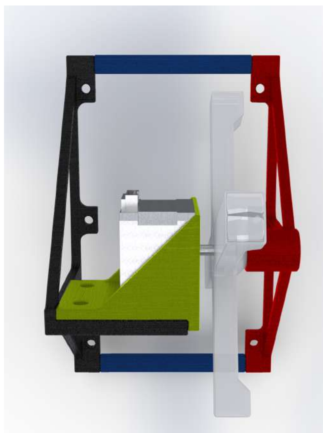
Obrázek 3.8: Barevně rozdělená soustava uchycení válce s krokvým motorem a křížem
