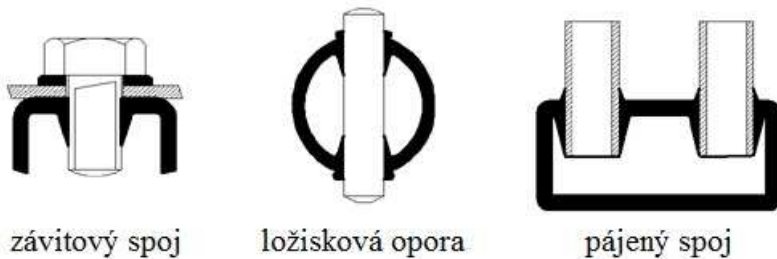
Obr. 35 Příklady spojů s pouzdry vytvořených termálním vrtáním [2]
