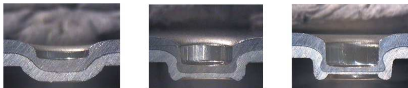
Obr.41 Postup při TOX klinčování [60].
