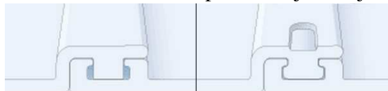
Obr. 25 Rozepření kuželovým kotoučem [46]
