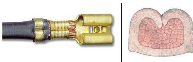
Obr. 28 Krimpovaný spoj a jeho řez [57], [22]
