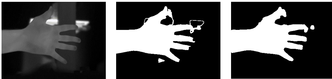
Obr. 6.6: Problematické prostředí pro IR oblast obsahující v pozadí 3D tiskárnu. Na prvním snímku se nachází zvolené prostředí, na druhém výsledek po segmentaci prahováním a třetím je vyobrazen snímek po úpravách
