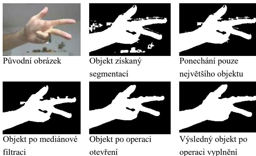
Obr. 5.4: Snímky s postupnými úpravami po segmentaci (získáno webovou kamerou Logitech S7500)
