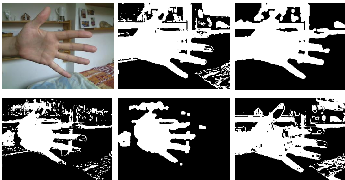
Obr. 6.11: Druhé problematické prostředí: První snímek v horním řádku zobrazuje zvolené prostředí, snímky napravo pak segmentaci v normalizovaném RGB všech tří složek a následné úpravy. První snímek ve spodním řádku zobrazuje segmentaci v YCbCr prostoru a to dle složek C_b a C_r , další pak snímek po úpravách a poslední snímek pak segmentaci získanou kombinací složek R a C_r (zde jsou nastavené prahy odlišné jako v přechozí variantě barevných prostorů zvlášť)
