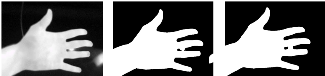
Obr. 6.5: Problematické prostředí pro IR oblast obsahující v pozadí napájecí zdroje. Na prvním snímku se nachází zvolené prostředí, na druhém výsledek po segmentaci prahováním a na třetím je vyobrazen snímek po úpravách
