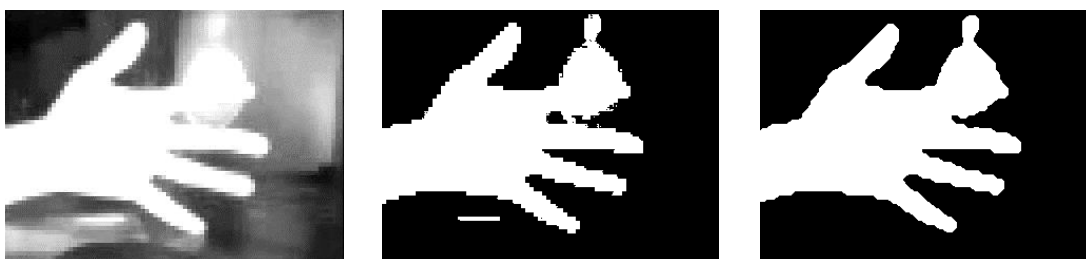
Obr. 6.8: Problematické prostředí pro IR oblast obsahující v pozadí aktivní reproduktor a tablet. Na prvním snímku se nachází zvolené prostředí, na druhém výsledek po segmentaci prahováním a třetím je vyobrazen snímek po úpravách
