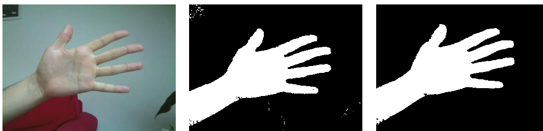
Obr. 6.10: Problematické prostředí pro VIS oblast obsahuje v pozadí červenou sedačku, list rostliny a obrázek. První snímek zobrazuje zvolené prostředí, snímek napravo pak segmentaci v normalizovaném prostředí RGB a složek R,G,B a poslední snímek pak výsledek po úpravách
