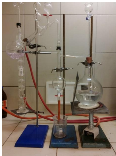
Obrázek 8: Destilační aparatura dle Parnase-Wagnera
