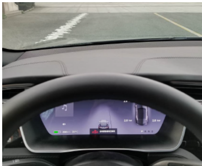
Obrázek 2.12: Upravená levá čára parkovacího místa což způsobuje to, že vozidlo nedetekuje parkovací místo.
