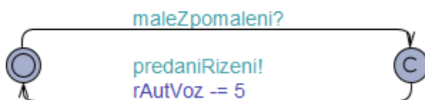
Obrázek 5.7: Automat, kterým se sníží rychlost vozidla o 5 \text{ km/h} .
