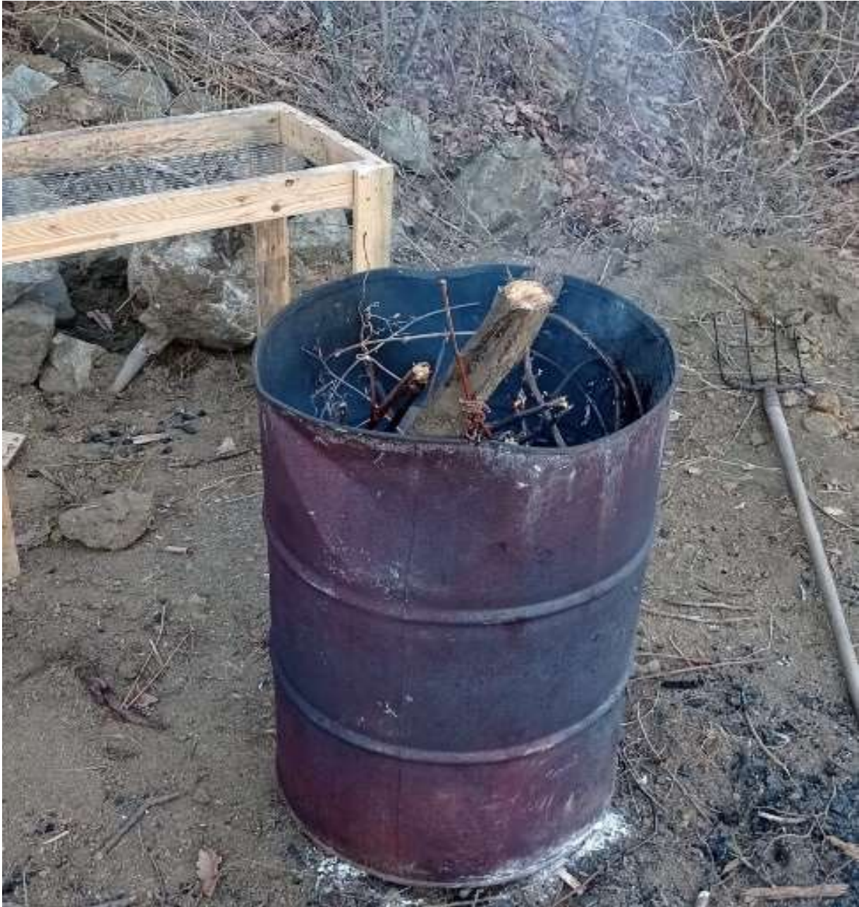
Obrázek 4 - Plechový sud použitý pro výrobu vzorků 1, 2 a 3. Na snímku je příprava vzorku č. 3, v pozadí je vidět síto použité pro oddělení frakce 0-15 mm.
