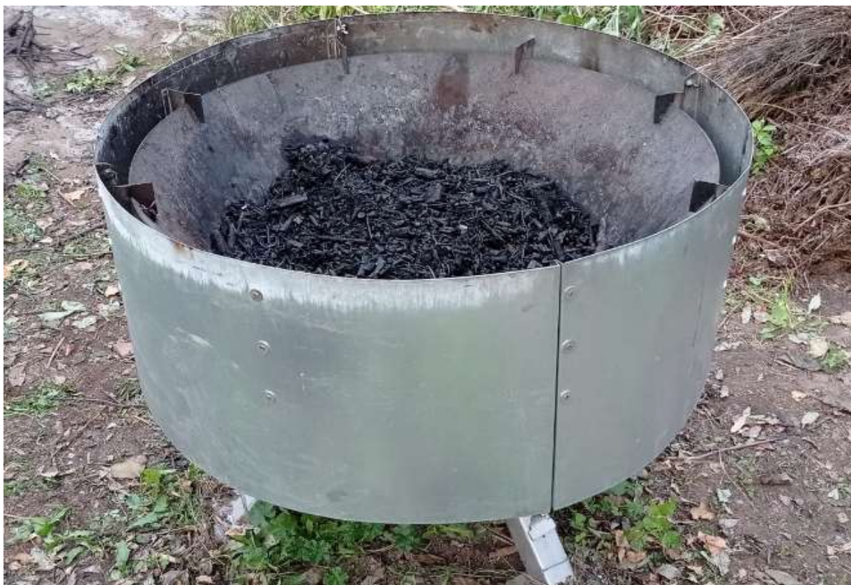
Obrázek 5 – Kon-Tiki pec pro domácí výrobu biouhlu, ve kterém byly vyrobeny vzorky č. 4 a 5. Tato pec má tvar převráceného komolého kužele, ve spodní části pece se nachází ventil pro vypuštění přebytku vody z hašení hořící biomasy. Zároveň lze tento ventil použít pro regulaci vstupu vzduchu do pece, čímž lze výrazně urychlit zapalování biomasy.
