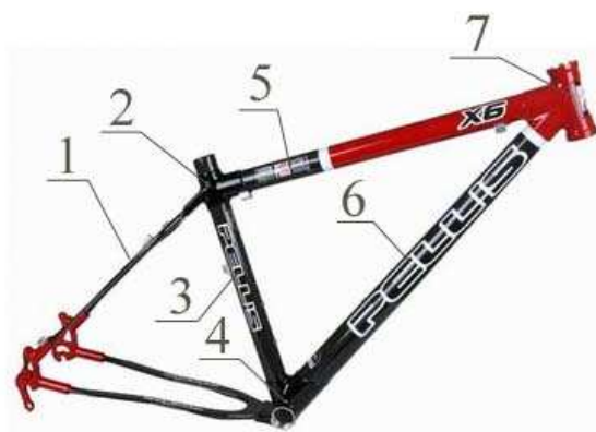
obr.14: Rozvržení rámu hardtail
