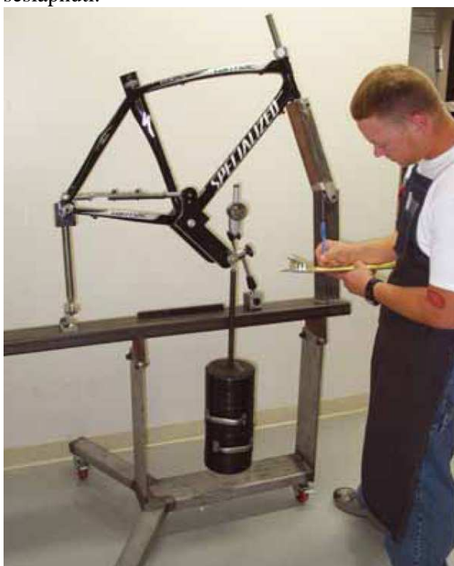
obr.34: Realizace zkoušky tuhosti zadní vzpěry
