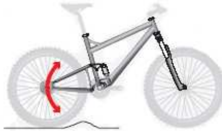
obr.25: Zadní odpružení s měnící se dráhou osy
