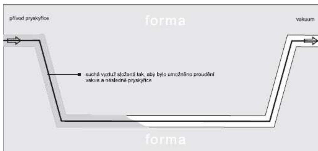
obr.12: Schéma metody vakuového prosvycování
