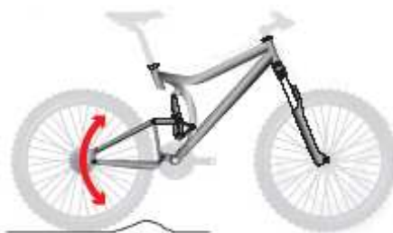
obr.22: Zadní odpružení s obloukovou dráhou osy
