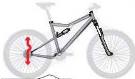
obr.23: Zadní odpružení s vypouklou dráhou osy
