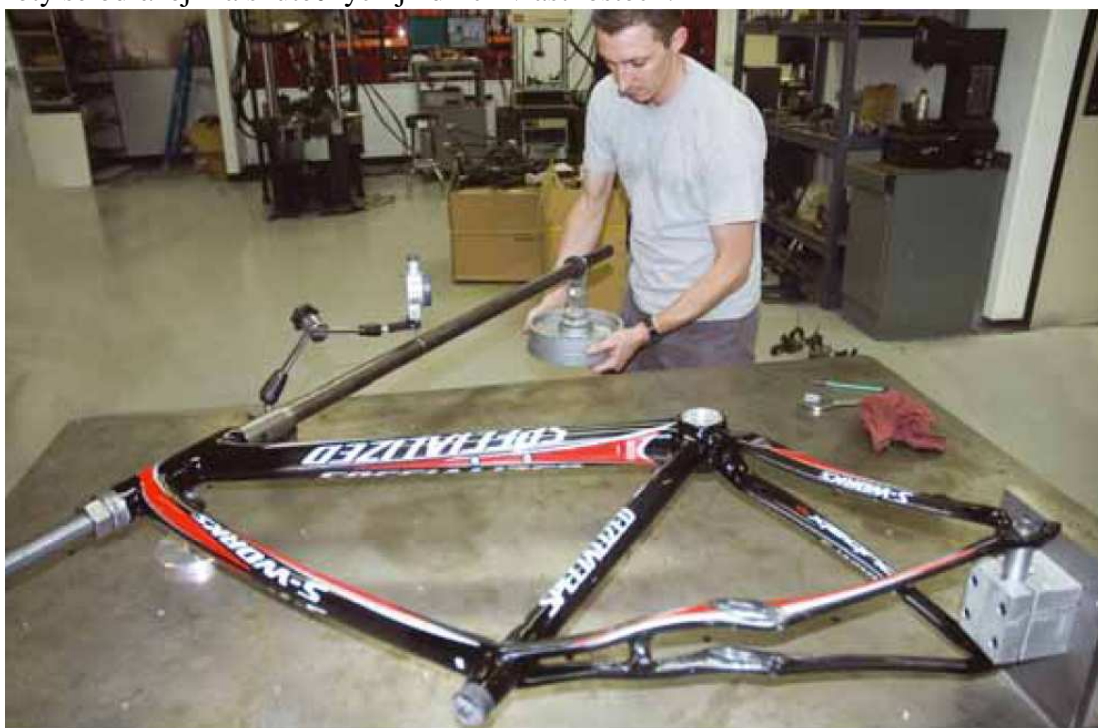
obr.32: Realizace zkoušky torzní tuhosti
