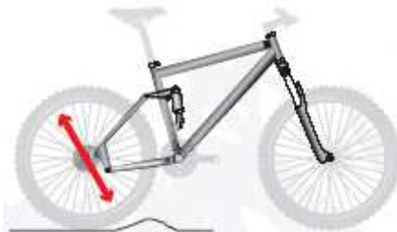
obr.21: Zadní odpružení s podélnou dráhou osy
