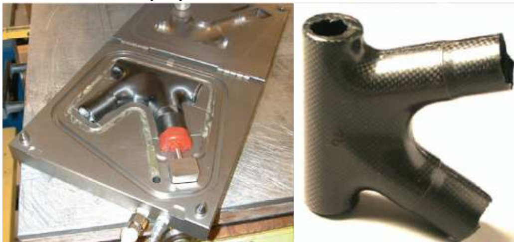
obr.28: Kompozitní spojka rámu
