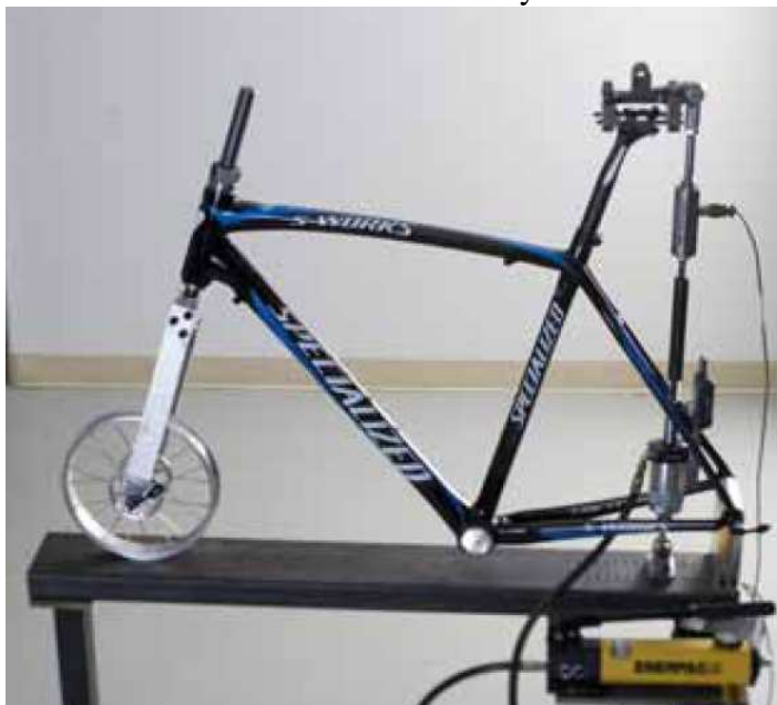
obr.33: Realizace zkoušky vertikální poddajnosti
