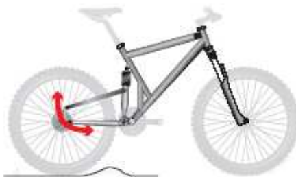
obr.24: Zadní odpružení s dráhou osy tvaru J
