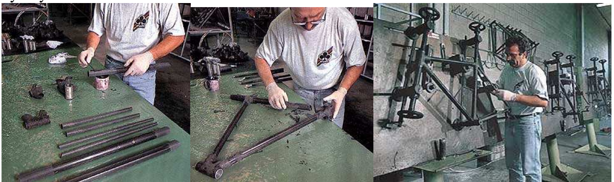
obr.26: Vlepování do spojek
