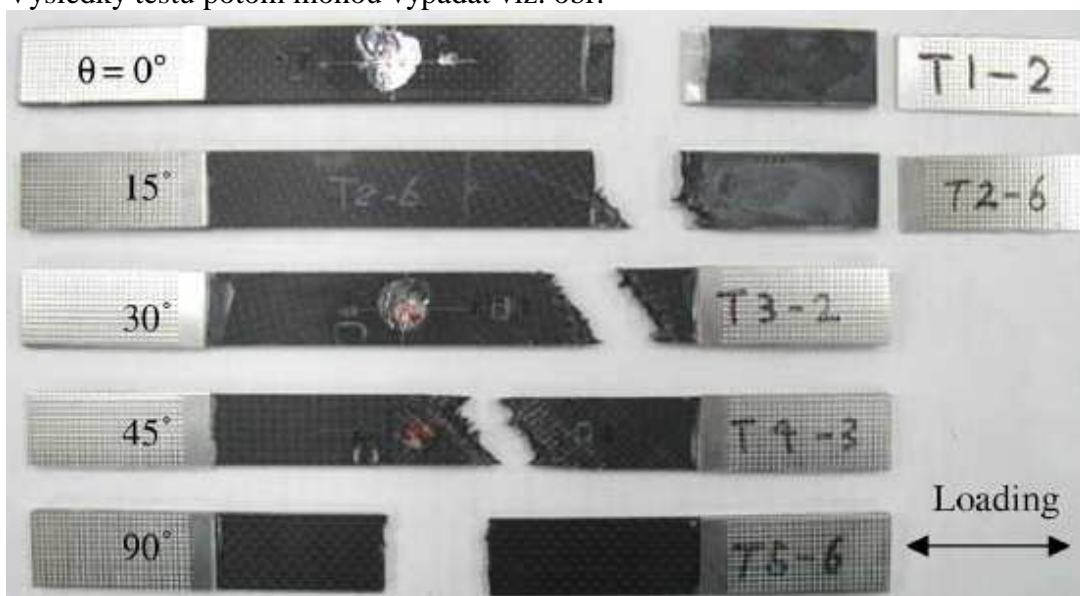
obr.30: Zkušební vzorky po provedení zkoušky tahem
