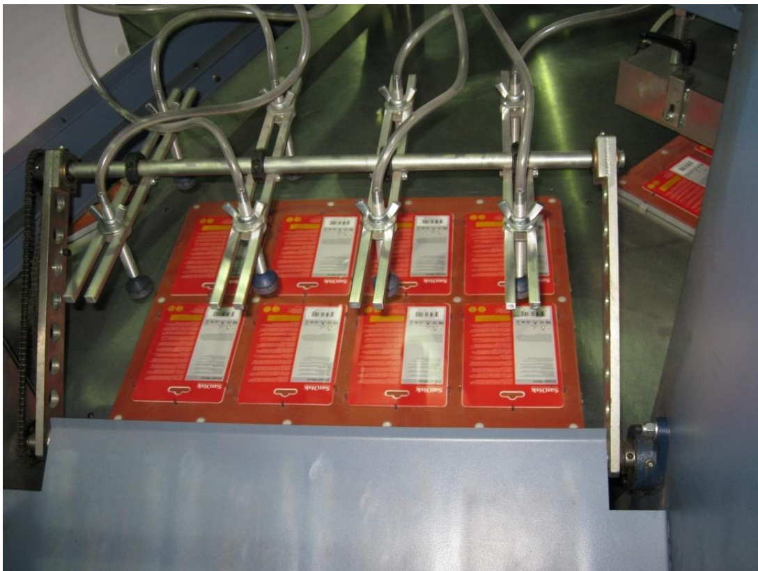
Obrázek 4: Podavač pro vyjmutí hotových výrobků a upuštění na skluz
