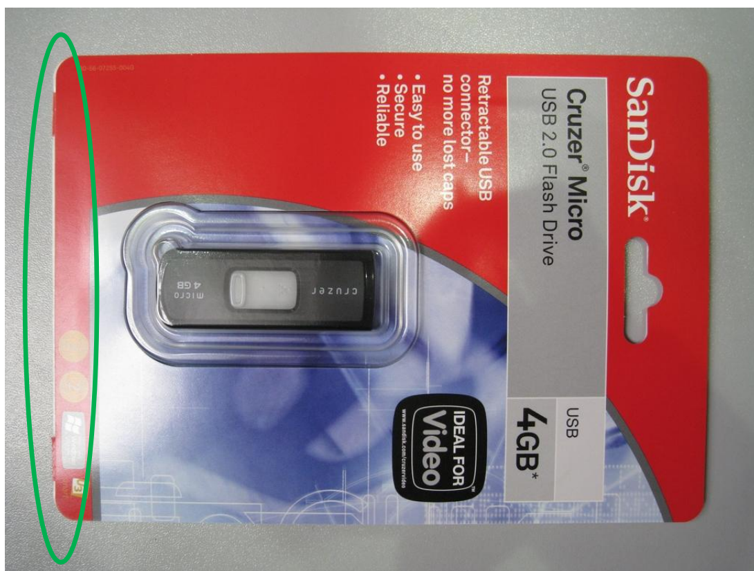
Obrázek 6: Neshodný výrobek, přesah zadní karty přes přední
