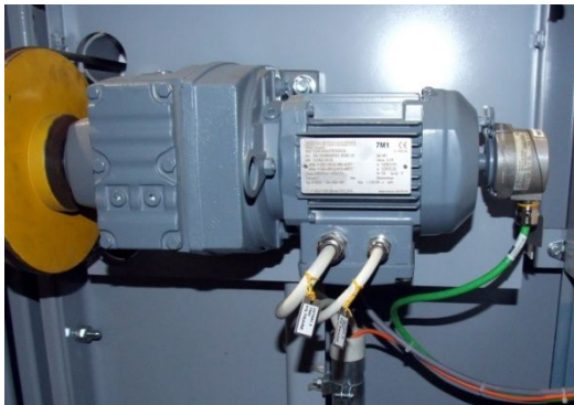
Obr. 26 - servomotor s resolverem, převodovkou a tažným lanem
