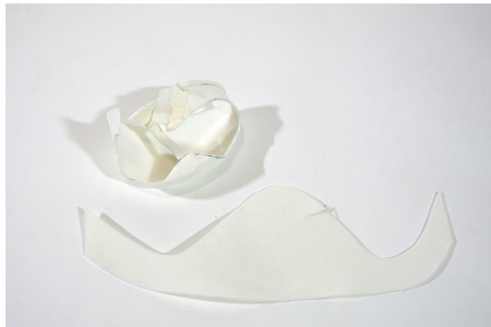
Obr. 26) Poreten, tvarování pomocí tepla
