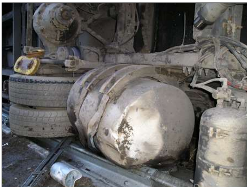
Obr.12 - Pohled na havarované vozidlo - hnací hřídel havarovaného tahače Volvo demontován před odtahem
