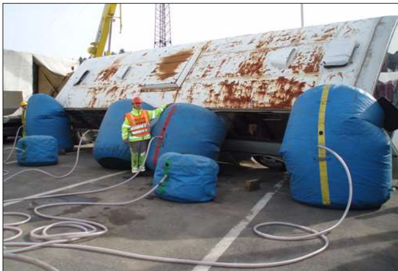
Obr. 8 - Plynulý, postupný zdvih autobusu pomocí vaků Fig. 8 - Continuous, gradual lifting of the bus by bags
