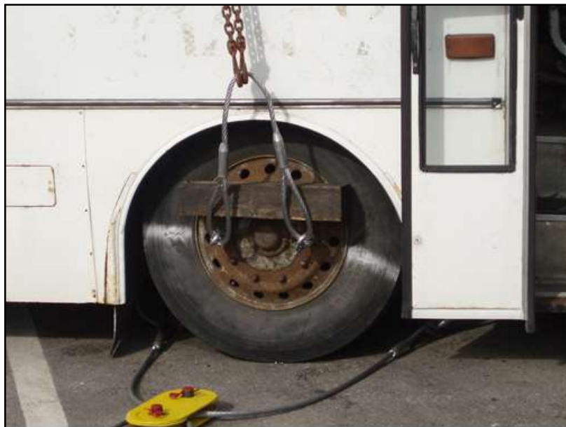
Obr. 3 - Uchycení jeřábu za kolové šrouby Fig. 3 - Fastening the crane by wheel screws
