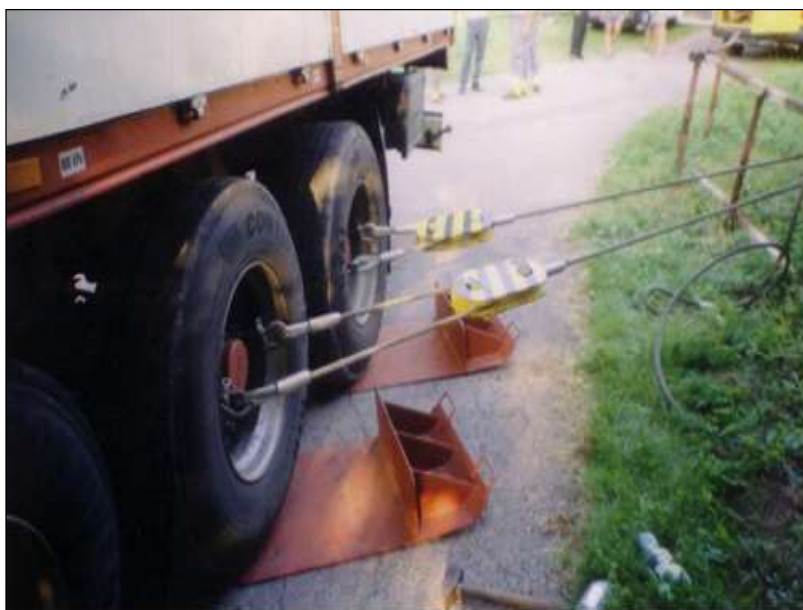
Obr. 11 Použití podložek k ochraně pneumatik při bočním Fig. 11 - Using sliding pads to protect tyres at side shift
