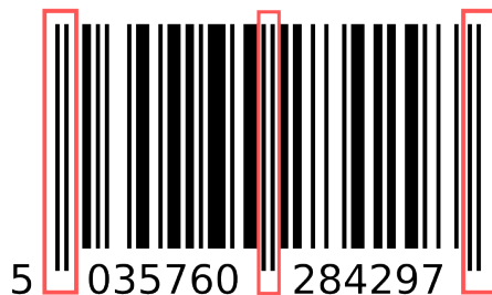
Obrázek 2.3: Okrajové a dělicí znaky kódu EAN.
