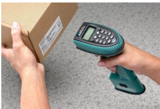
Obrázek 2.4: Ruční laserový scanner. Převzato z [3].
