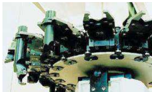
Obr. 5.3 Kotoučový systém výměny nástrojů svislých soustruhů řady POWERTURN společnosti TOSHULIN [9]
