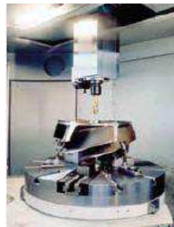
Obr. 2.4 Vyvrtávání na vertikálním soustruhu [9]
