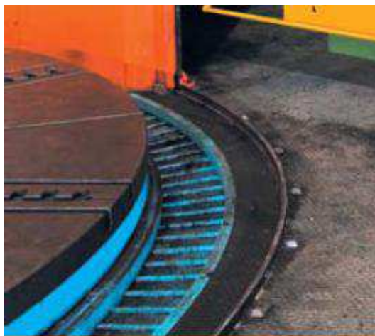
Obr. 4.16 Článkový dopravník třísek [8]
