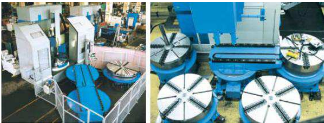
Obr. 5.4 Paletizační systém společnosti TOSHULIN [9]
