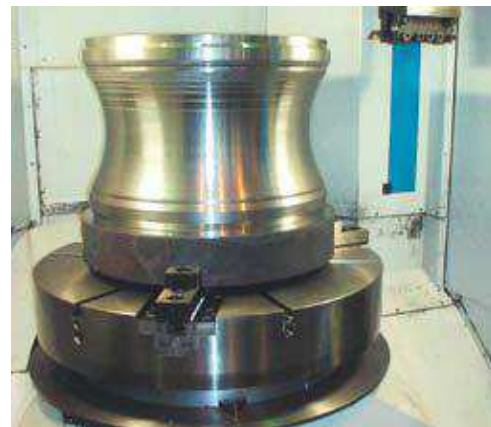
Obr. 2.2 Soustružení kuželových, zaoblených ploch [9]
