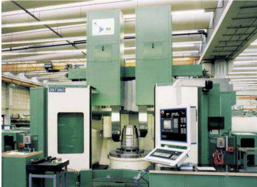
Obr. 6.4 Vertikální soustruh CONTUMAT – VCE 1400 [12]
