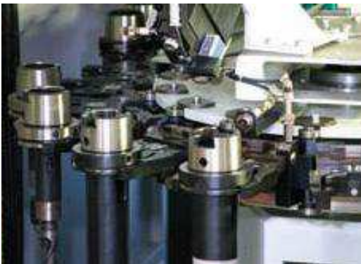
Obr. 5.2 Systém výměny nástrojů svislých soustruhů řady POWERTURN společnosti TOSHULIN [9]
