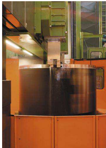
Obr. 2.1 Soustružení vnější válcové plochy [8]
