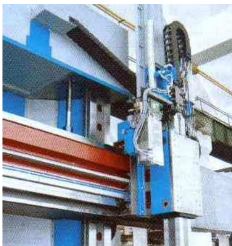
Obr. 4.7 Příčník s příčnickovým suportem [5]
