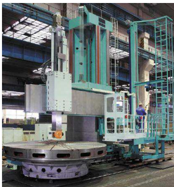
Obr. 3.1 Jednostojanový svislý soustruh [8]
