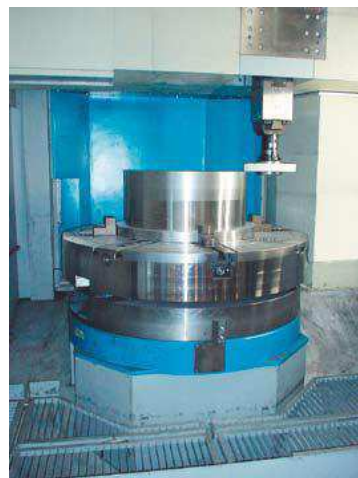
Obr. 2.3 Broušení válcových ploch [9]
