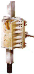
Obr. 4.4 Hydrostatické uložení smykadla [5]
