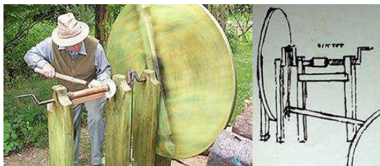
Obr. 1.2 Kresba soustruhu Leonarda da Vinciho a Stuart Kingsova rekonstrukce soustruhu [2]
