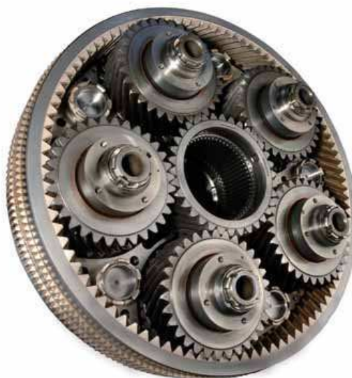
Obr. 8: Planetová převodovka motoru PW1000G [13]
