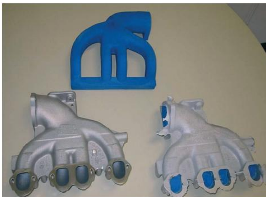
Obr. 16: Použití pojivového systému CORDIS při výrobě sacího potrubí [8]
