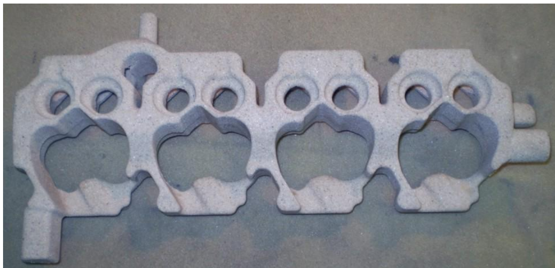
Obr. 26: Příklad jádra hlavy motoru s využitím pojiva Kožní kliš K-2 [1]
