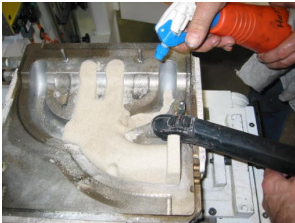
Obr. 18: Čištění jaderníku vodou a vysavačem [28]
