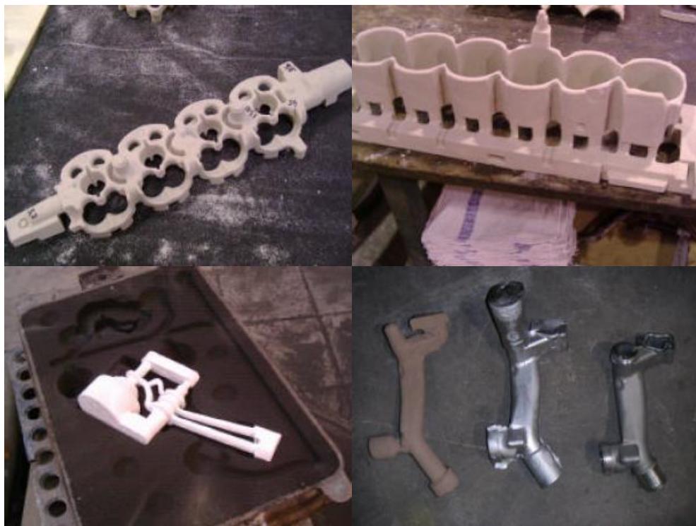
Obr. 19: Příklady jader s použitím pojiva BeachBox ® [28]
