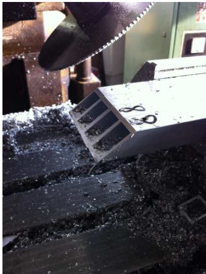
Frézovanie profilov pod uhlom, ustavený zýklad rámu na zväracom stole
