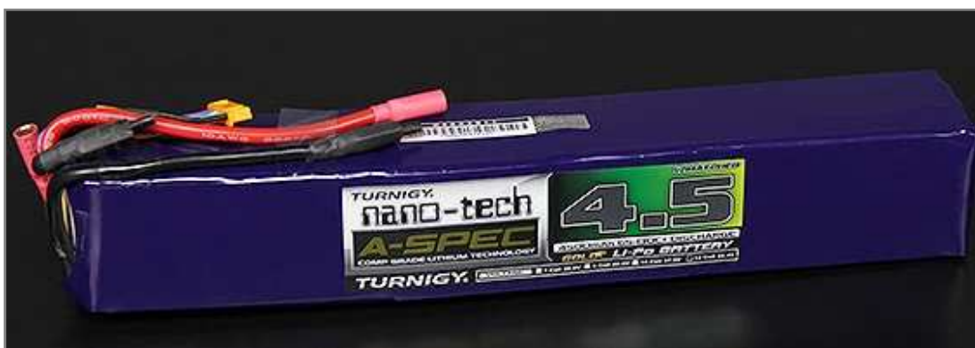
Obr.3-7 Použitá batéria Turnigy A-spec nanotech
