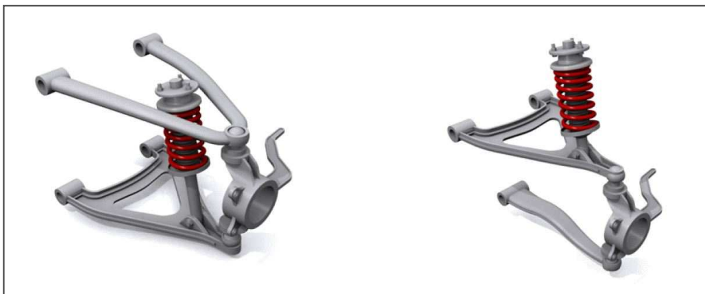
Obr.1-30 Možnosti uchytenie tlmiča na lichobežníkové zavesenie kolies[21]
