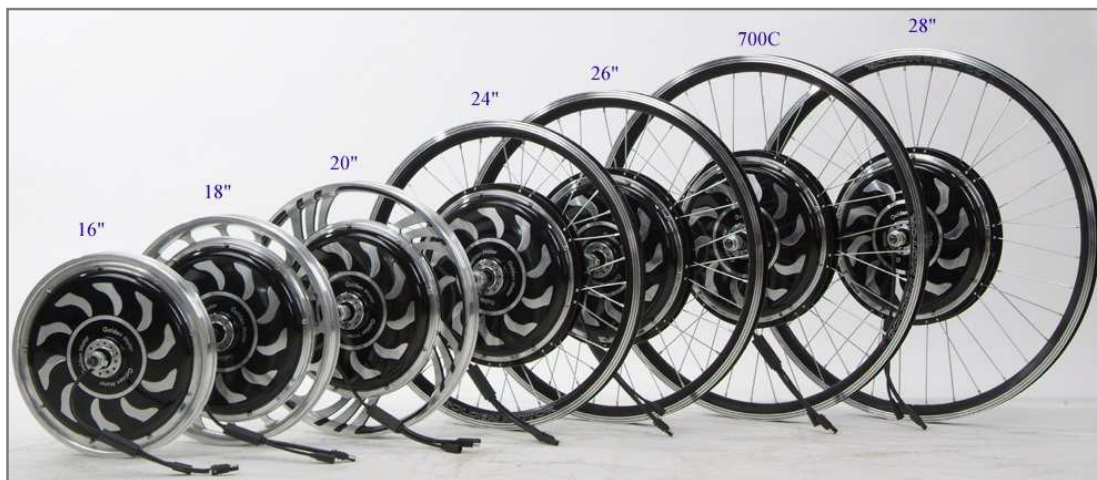
Obr.3-1 Veľkosti ráfikov cyklokolies (na obrázku s elektromotorom v náboji) [23]
