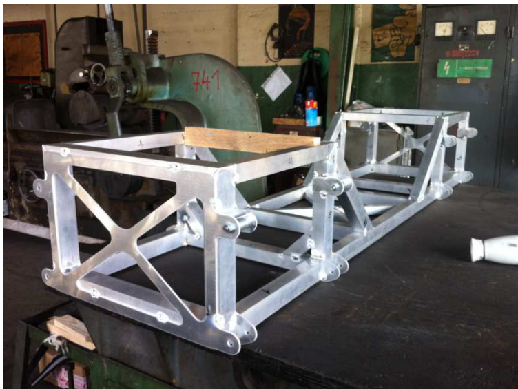
Prípravok pre zváranie ramien zavesenia, zvarení základ rámu s konzolami
