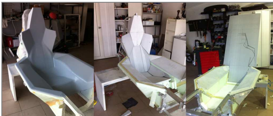
Obr. 4-16 Realizácia formy sedadčky priamo na rám
