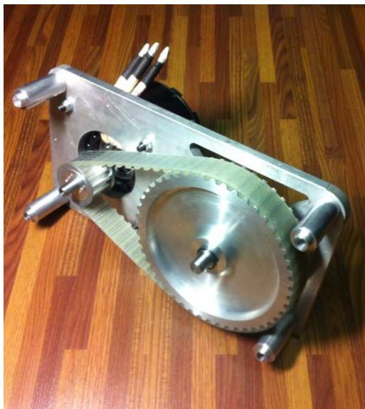
Prevodovka bez zadnej steny, kompletná prevodovka osadená motorom
