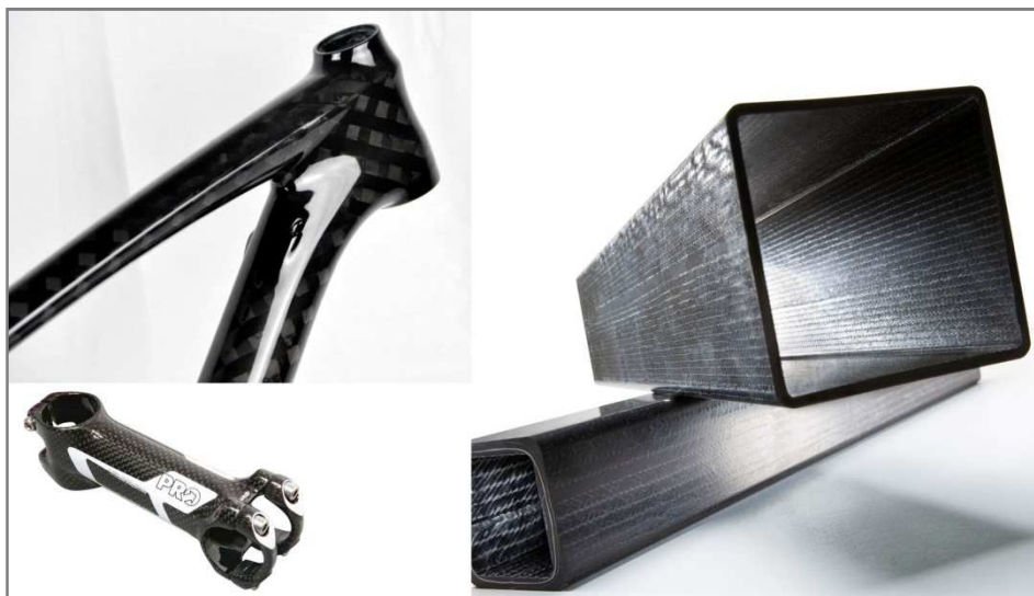
Obr.1-19 Príklady použitia uhlíkových kompozitov[27]
