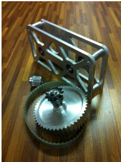
Prevodová skriňa a ozubené kolesá, zostava zadnej poháňanej osy
