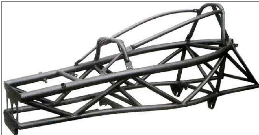
Obr.1-20 Priestorový nosný trubkový rám [15]
