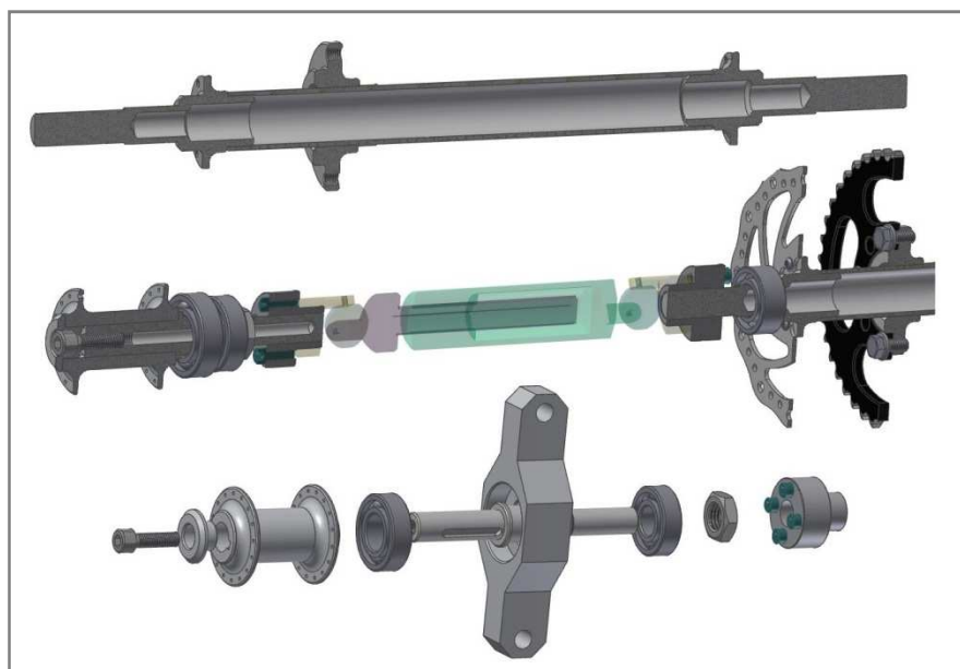
Obr.4-14 Dutá zadná osa (hore) / rez kompletnou osou náhonu (uprostred) / uloženie náboja v tehlici
