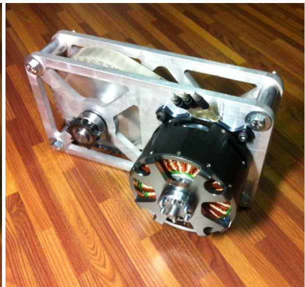
Prevodovka bez zadnej steny, kompletná prevodovka osadená motorom
