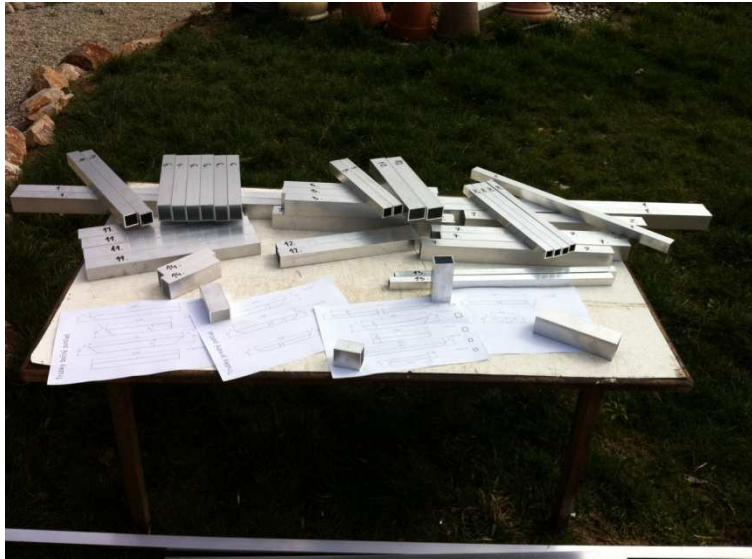
Polotovary na výrobu rámu a jeho rezanie na presné rozmery
