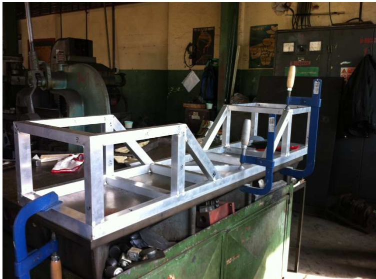
Frézovanie profilov pod uhlom, ustavený zýklad rámu na zväracom stole
