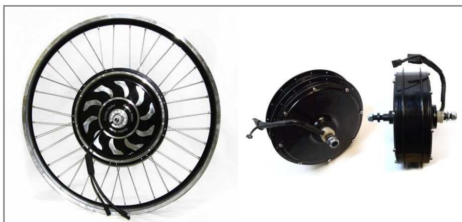
Obr.1-15 Motory v nábojoch kolies od firiem Goldenmotors / Crystalite [23] [22]
