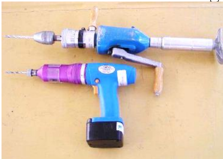
Obr. 3.4 Vrtačka pro zkoušení pevnosti malty ve spárách – ruční TZÚS a PZZ 01 [4]
