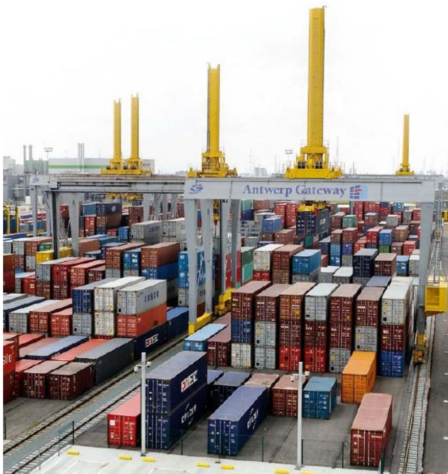
Obr. 18 Automatizované stohovací jeřáby od společnosti Gottwald port technology [37]
