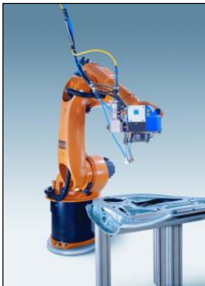
Obr. 24 Trumpf PFO 33 (Programovatelná Fokusační Optika) – první robotem řízená skenerová optika, která byla nasazená v sériové výrobě německých automobilek ke svařování součástí karoserií [17]
