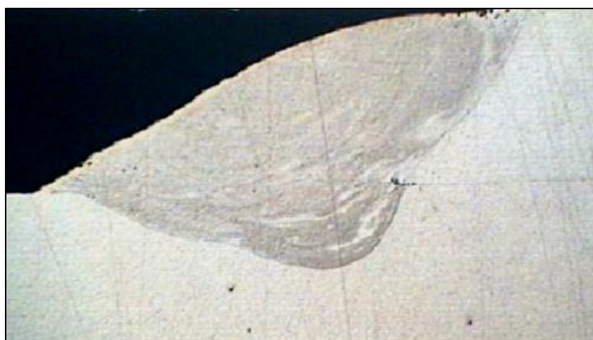
Obr. 17 Makrostruktura přeplátovaného spoje Al provedeného LaserHybridem - Řez koutovým svarem na přeplátovaném materiálu Al tl. 30 a 8 mm velmi dobře dokumentuje jak lze při správném seřízení dokonale spojit i velmi masivní materiály pouhým jednovrstvým svarem [14]
