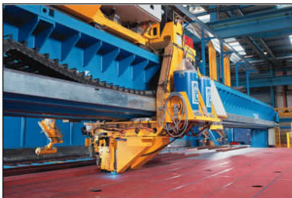
Obr. 28 Svařování koutového a tupého svaru při výrobě panelů lodních trupů v loděnicích J. L. Meyer GmbH [22]
