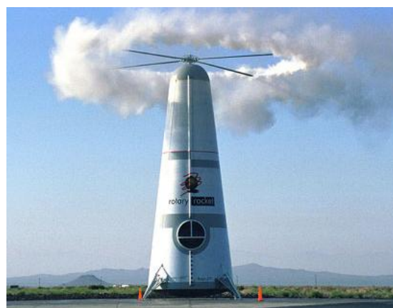
Obr. 4-2. Test přistávací vrtule rakety Roton, [58]
