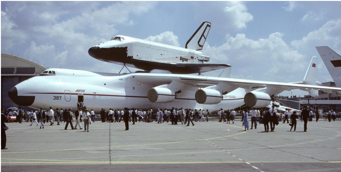
Obr. 3-7. Transport raketoplánu Buran na hřbetu letounu An-225, [55]
