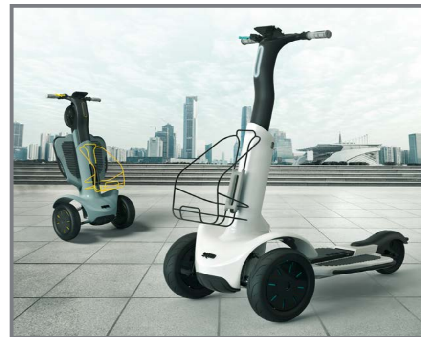
Obr. 40 Rozložená a složená finální varianta skútru
