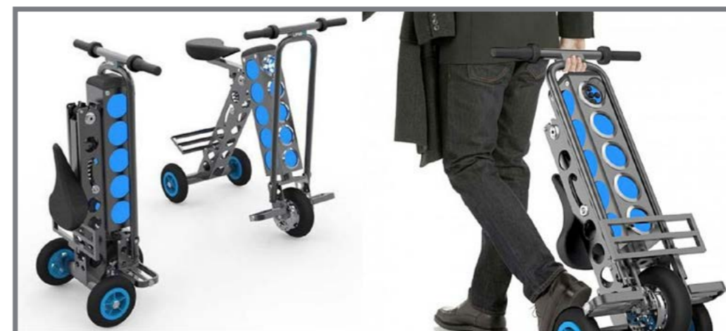
Obr. 25 Urb-e v pojízdné a složené fázi [27]
