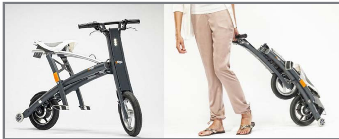
Obr. 26 Stigo v pojízdné a složené fázi [28]
