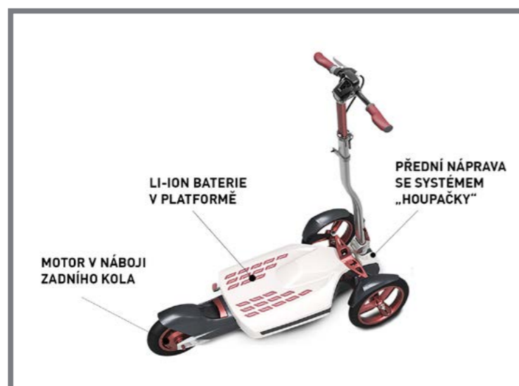
Obr. 14 MUV-e: umístění důležitých technických komponentů [10]
