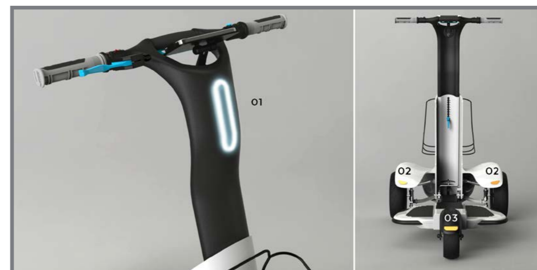
Obr. 71 Osvětlení skútru: 01 přední světlomet, 02 reflexní odrazky, 03 zadní světlomet
