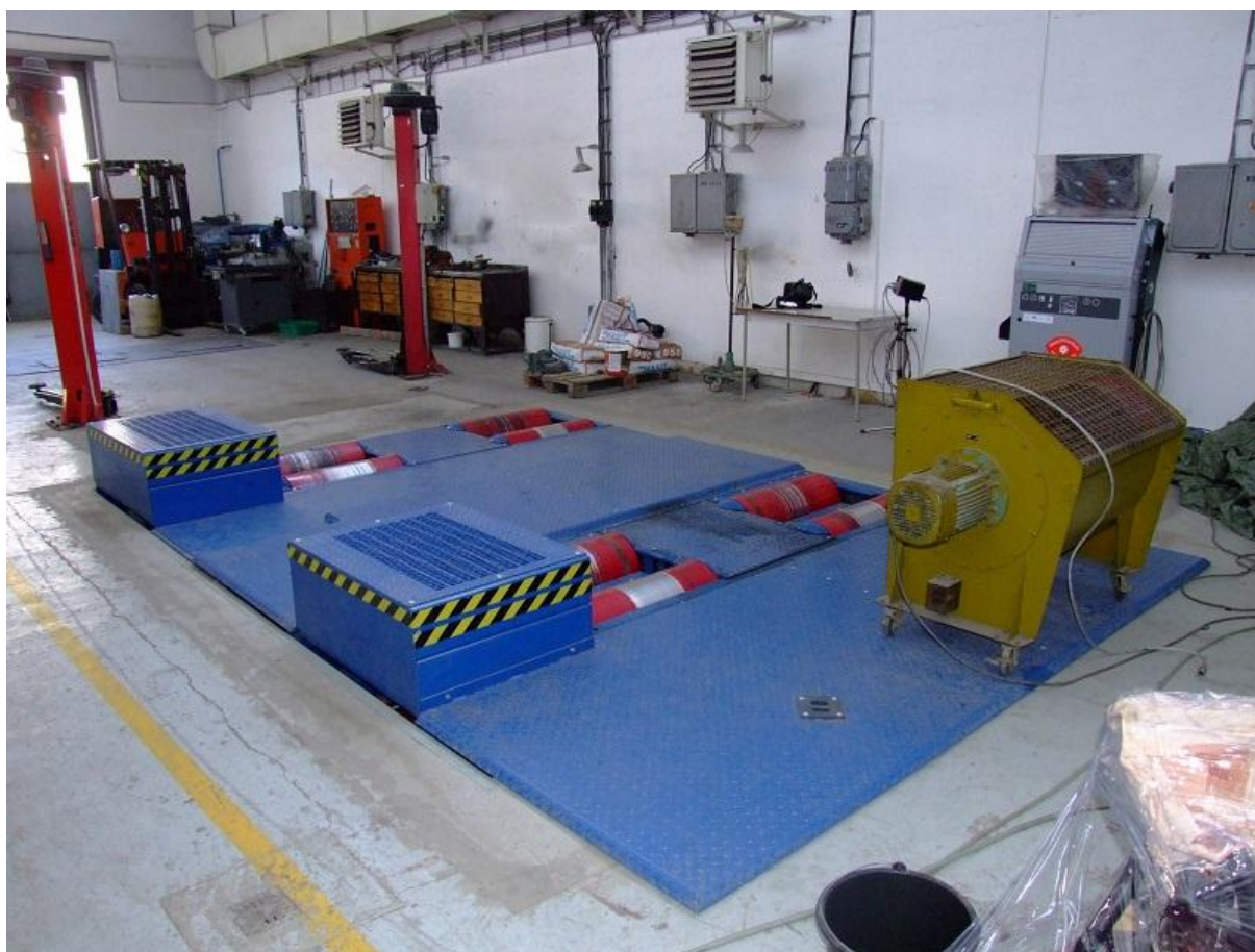
Obr. 2.1 Válcová výkonová zkušebna MAHA LPS 3000 R100/2, VUT Brno
