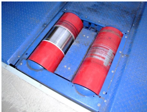
Obr. 2.3 Detail válců zkušebny
