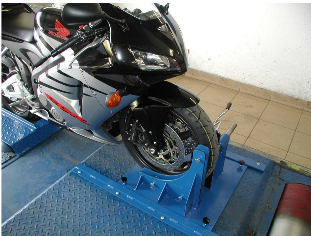
Obr. 1.7 Zajištění polohy motocyklu konstrukcí fy MAHA
