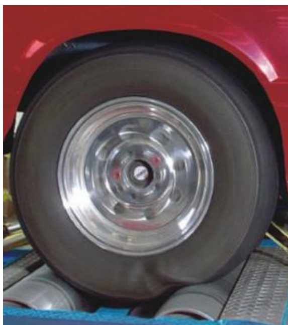
Obr. 1.6 Deformace pneumatiky automobilu během výkonové zkoušky na dvouválcové zkušebně [10]
