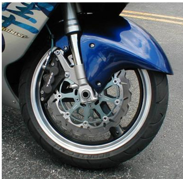
Obr. 3.6 Příklad uzpůsobení brzdového systému motocyklu Suzuki GSX-R 1300 Hayabusa [17]
