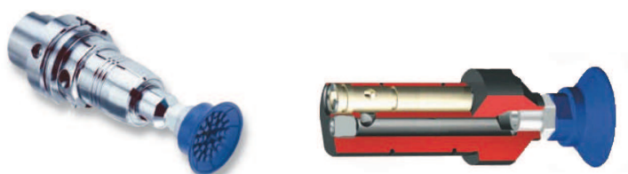
Obr. 3.0.2.: Podtlaková úchopná hlavice SCHUNK GSW-V s Venturiho tryskou pro vytvoření podtlaku [12]
