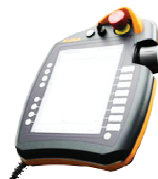
Obr. 6.3.4.: Teach-pendant s dotykovým displejem KUKA SMARTPAD [15]
