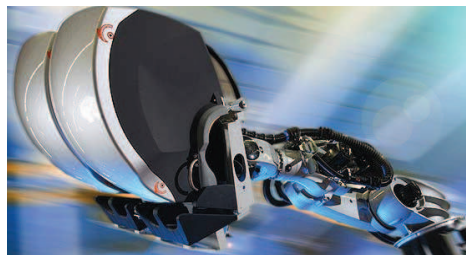
Obr. 3.1.2.: Speciální hlavice pro zábavní průmysl KUKA Robocoaster [29]
