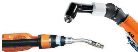
Obr. 3.1.1.: Technologické hlavice pro svařování a lakování [16]
