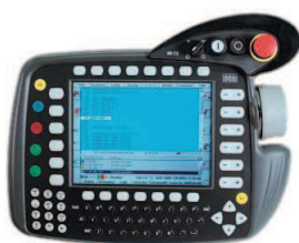
Obr. 6.3.3.: Klasický teach-pendant KUKA KR C2 [31]
