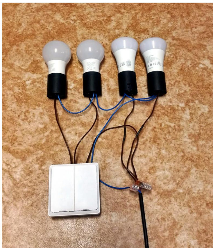
Obr. 4.7: Zapojení chytrého vypínače Tesla a chytrých zářivek Philips Hue (dvě zprava)
