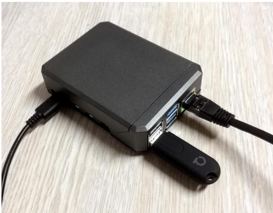
Obr. 4.2: Raspberry Pi 4 s připojenou ZigBee-USB bránou ConBee II
