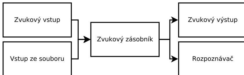
Obrázek 5.1: Schéma zvukového vstupu a výstupu
