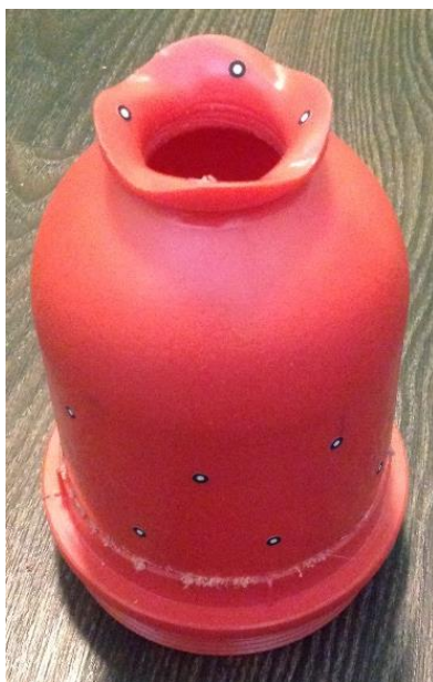
Obr. 18 Skenované potrubí s referenčními body
