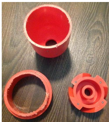
Obr. 19 Rozřezané skenované potrubí
