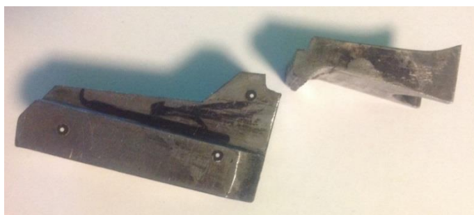
Obr. 24 Skenovaná součást přelomená na dvě části
