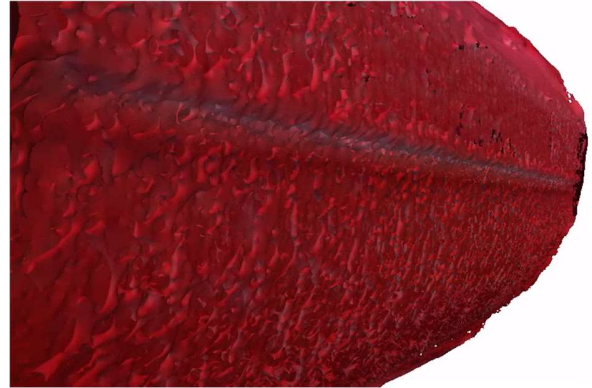
Obrázok č.22 Detail mesh modelu pri nezbavení sa Invert Points
