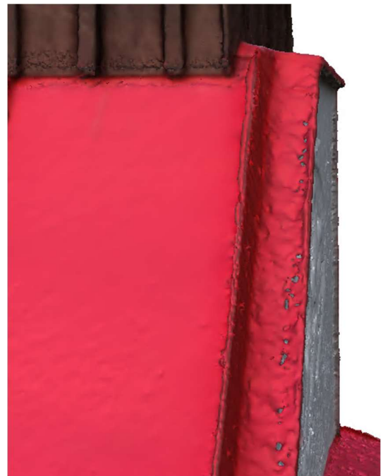
Obrázok č.24 Ukážka opravovaných drobných dier mesh modelu v projekte FML
