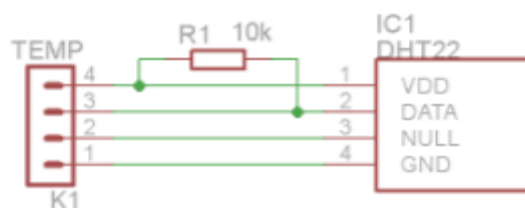
Obr. 5.1-10 obvodové zapojenie teplotného snímača
