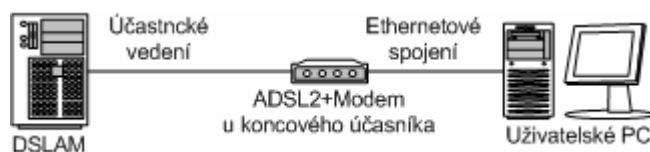
Obr. 7.26: Schéma zapojení při měření standardu ADSL2+ u reálných klientů.
