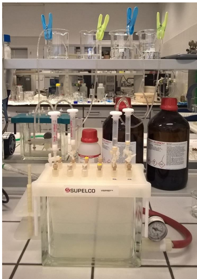
Obrázek 14: SPE extrakce – nanášení vzorku na extrakční kolonky
