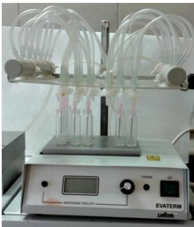
Obrázek 15: Sušení eluátu pod proudem dusíku
