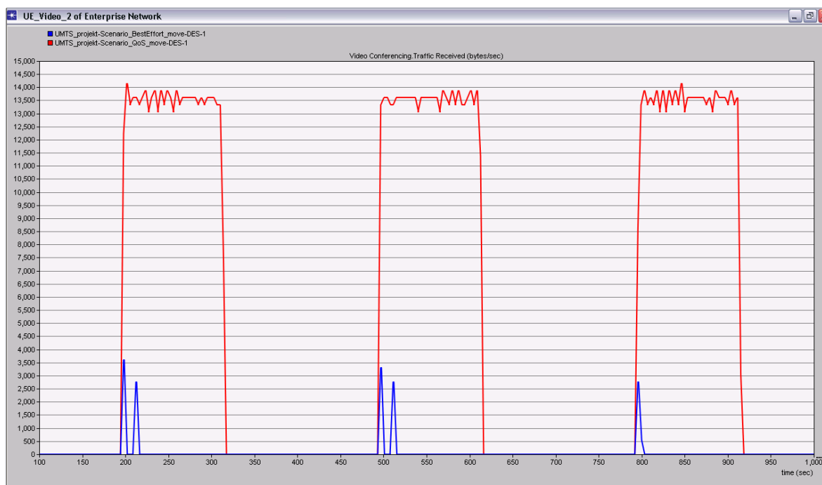
Obr. 6.26: Chování aplikace videotelefonie pro přijatá data v porovnání scénářů QoS a Best Effort
