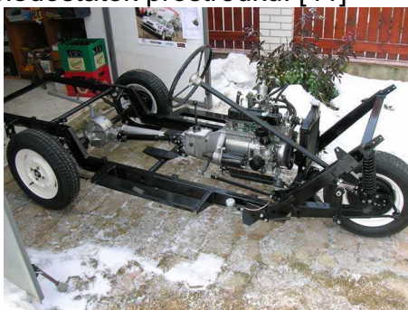
Obrázek 1.22 – Podvozek vozu Regal na kterém byla laminátová karoserie [21]
