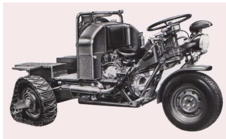
Obrázek 1.8 – Mechanická mula s nasazenými pásy [7]
