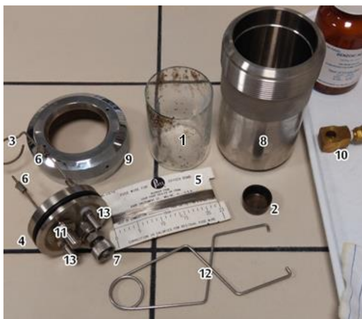
Obr. 25 Části kalorimetru [44] 1. skleněná kádinka, 2. kovový kelímek, 3. držák kelímku, 4. víko spalovací bomby, 5. spalovací drát, 6. svorky spalovacího drátu, 7. jehlový ventil, 8. spalovací bomba, 9. šroubovací převlečné víko, 10. plnicí konektor kyslíku, 11. plnicí ventil bomby, 12. kleště, 13. elektrody 58
