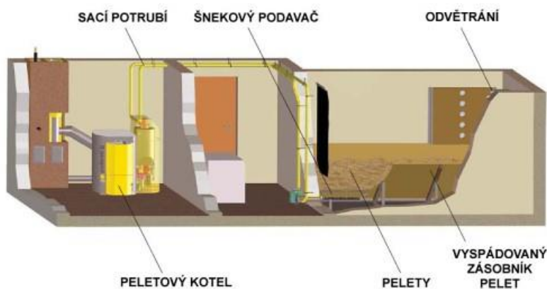
Obr. 7 Kotelna s odděleným skladem pelet [23]
