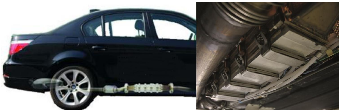
Obr. 10 Umístění termogenerátoru v automobilu BMW řady 5 [11]
