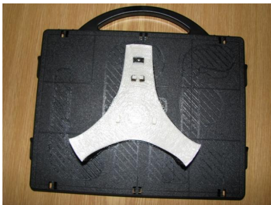
Obr. 4.10 Vyrobený model s podporou na podložce.
