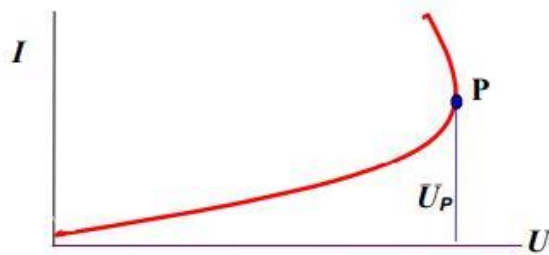
Obrázek 2.11 Elektrická pevnost U_p v závislosti na výkonu rozptýleném v materiálu
