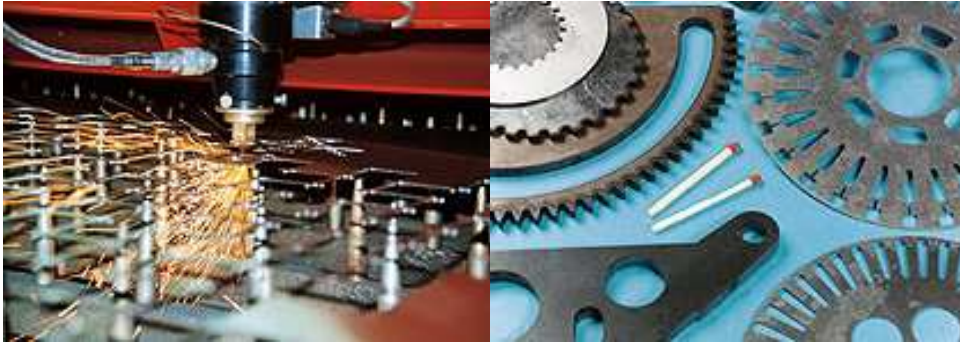
Obrázek 2.1 - ukázka řezání laserem, - vyřezané výrobky [4]
