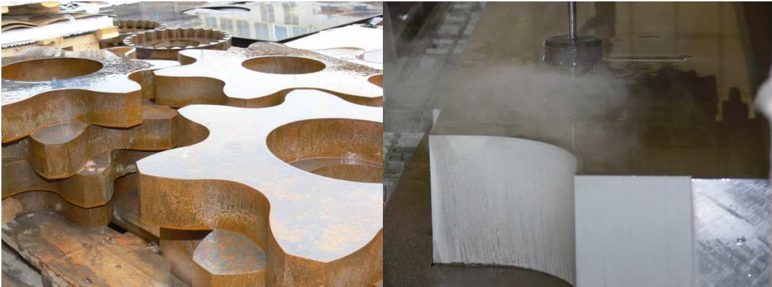
Obrázek 4.2 Příklady výrobků - ocel tloušťky 60 mm, - hliník tloušťky 150 mm [17]
