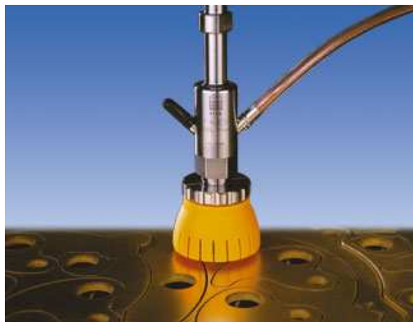
Obrázek 4.5 Řezací hlava firmy Flow Europe GmbH pro hydroabrazivní řezání [19]
