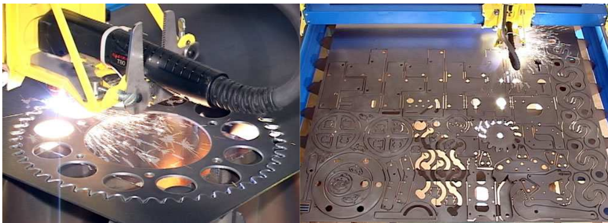
Obrázek 3.3 Příklady výrobků - řezání plazmou [11]
