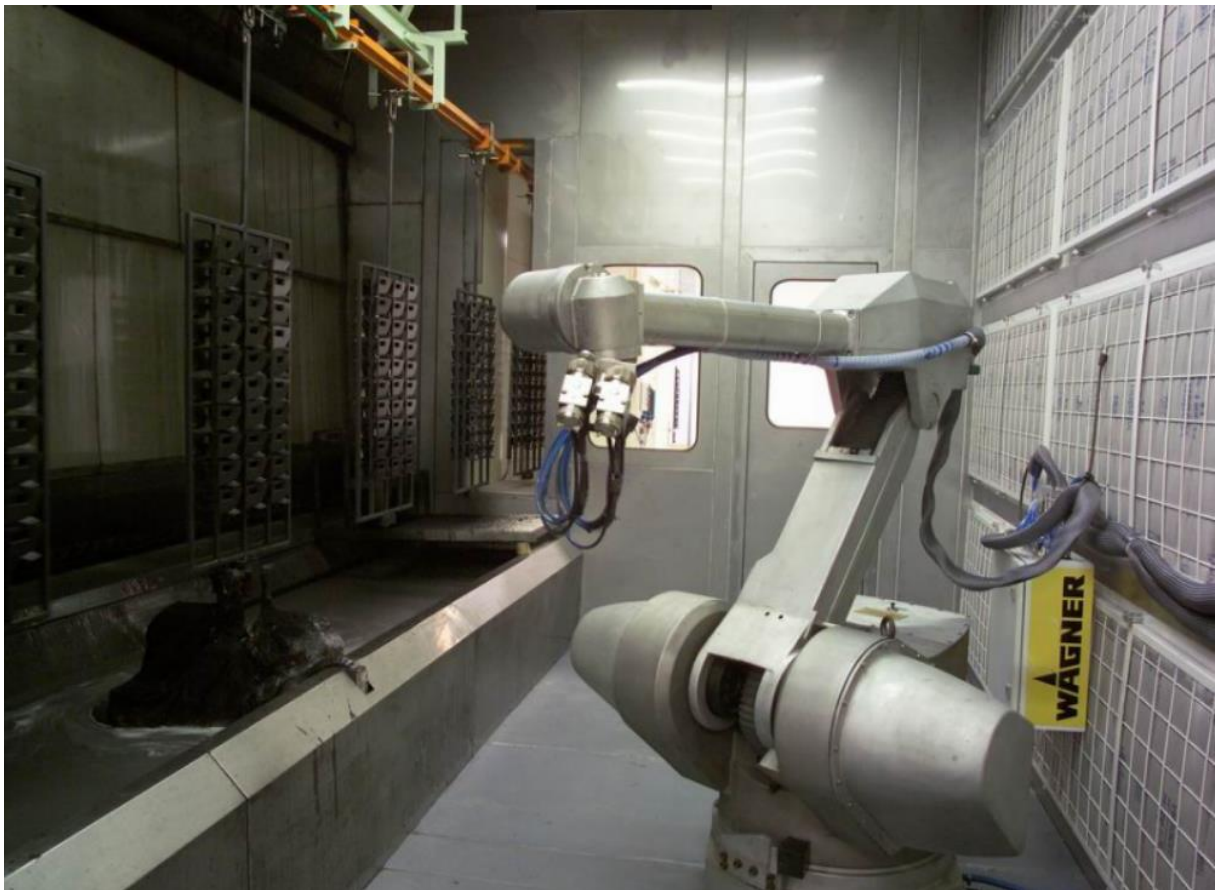
Obrázek 6: Lakování výlisků pomocí robota (Zdroj: vlastní zpracování)
