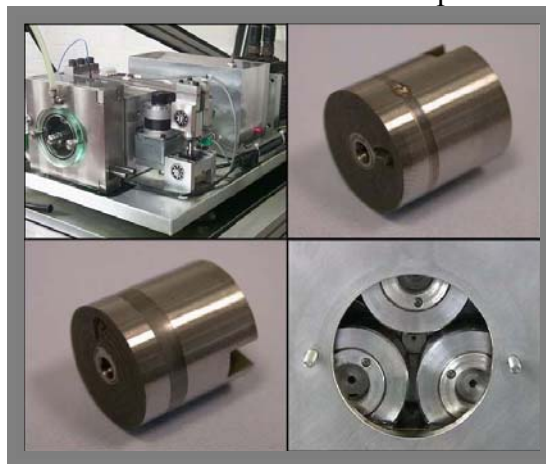
Obr. 7: Zkušební zařízení Micro-Pitting Rig [10]
