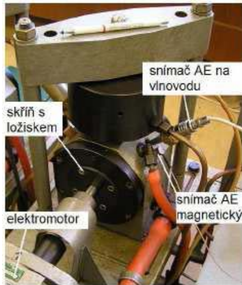
Obr. 6: Zkušební zařízení AX-MAT [5]
