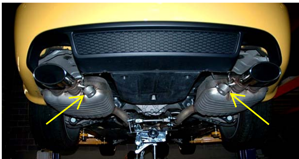
Obr.6 Pohled na výfukovou soustavu s pneumatickými akčními členy na voze Audi RS4 [18]
