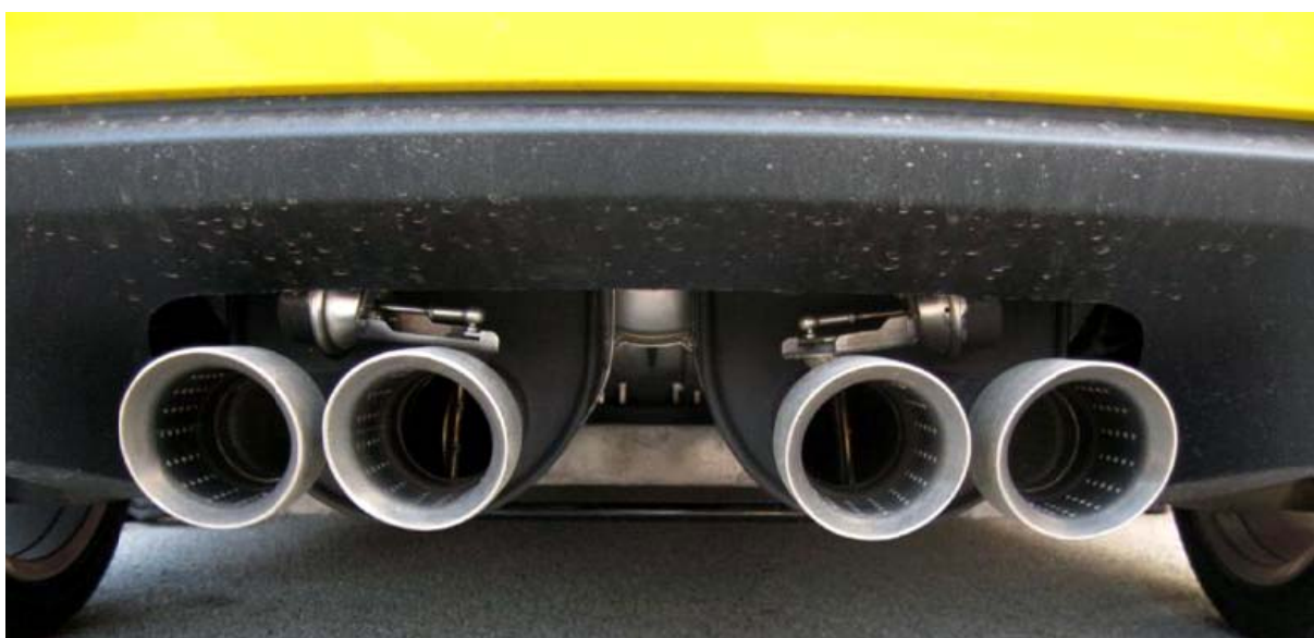
Obr. 26 Pohled na výfukové klapky s pneumatickými členy u vozu Chevrolet Corvette Z06 [29]
