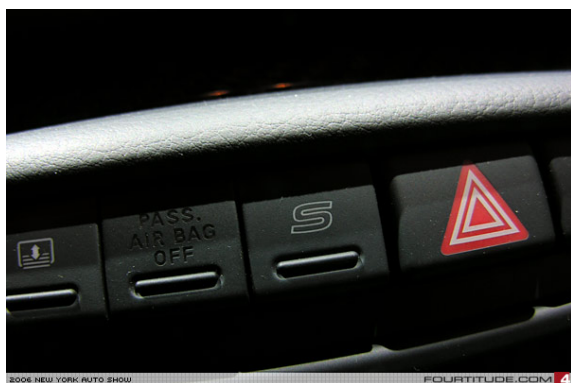
Obr. 11 Tlačítko „S“ umístěné na volantu pro navolení sportovnějšího režimu motoru s otevřením výfukových přívěr u vozu Audi RS4 [21]
