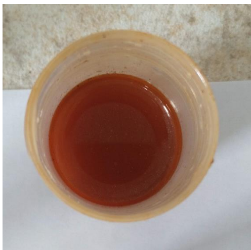
Obrázek 22: Zbarvení SBF u vzorku č. 9 poukazuje pravděpodobně na uvolnění oxidů železa do roztoku
