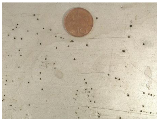
Obrázek 8: Ukázka bodové koroze na korozivzdorné oceli [39]
