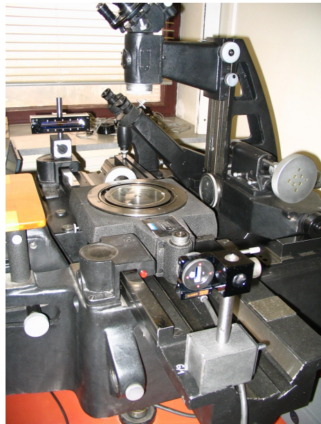
obr. 4.3 – měření přímosti osy X na mikroskopu
