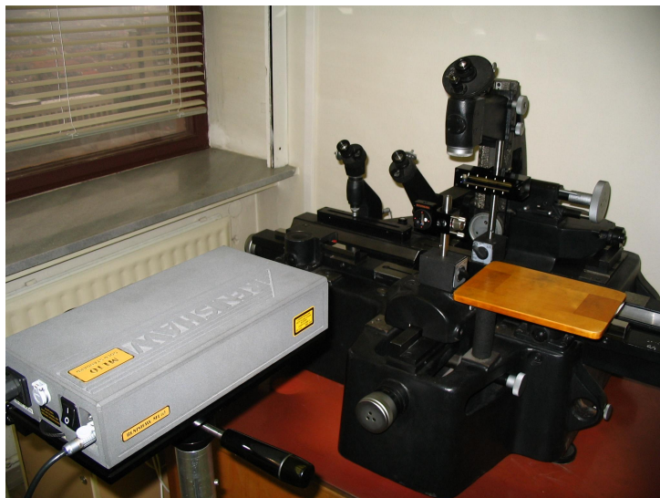
obr. 4.4 – měření přímosti osy Y na mikroskopu
