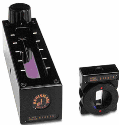
obr. 3.2 – interferometr a odražeč
