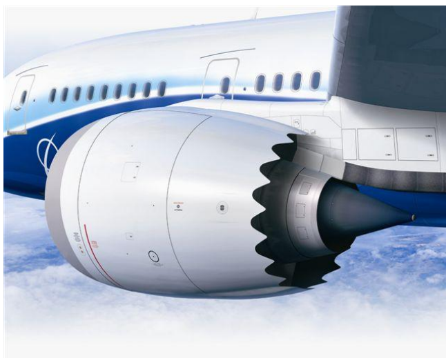
Obr. 6 Vykrojení krytu motoru pro snížení hluku 55
