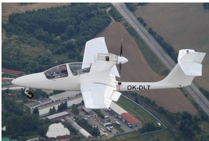
Obr. 13 Letoun VUT 061 Turbo s motorem TP100 72
