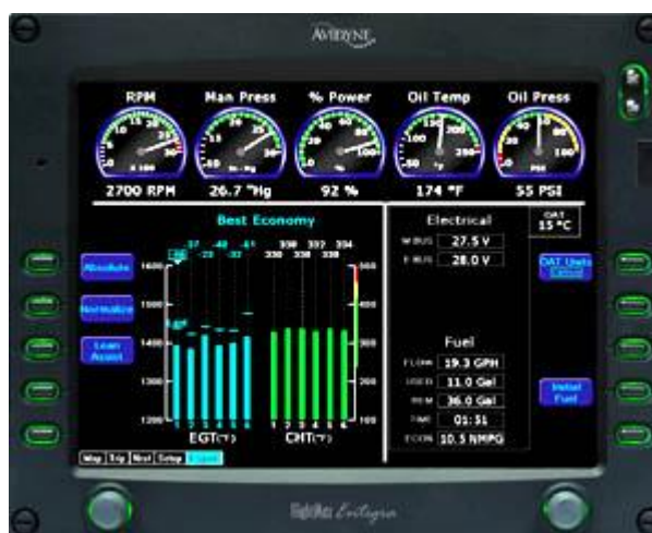
Obr. 7 Informace ze systému FADEC zobrazené pilotovi 60
