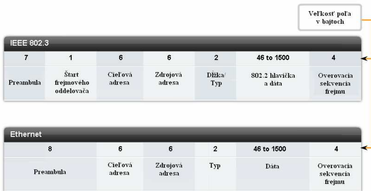
Obr. 3.: Porovnanie rozdielov Ethernetových štruktúr- 802.3 a Ethernet
