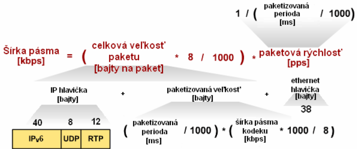
Obr. 14.: Vzorec výpočtu celkovej veľkosti šírky pásma VoIP hovoru
