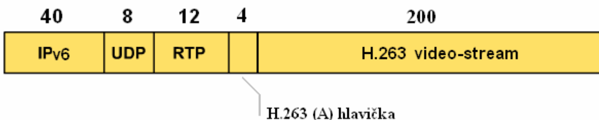
Obr. 19.: Zapúzdrenie video paketu a jeho veľkosť (bez Ethernet záhlavia)
