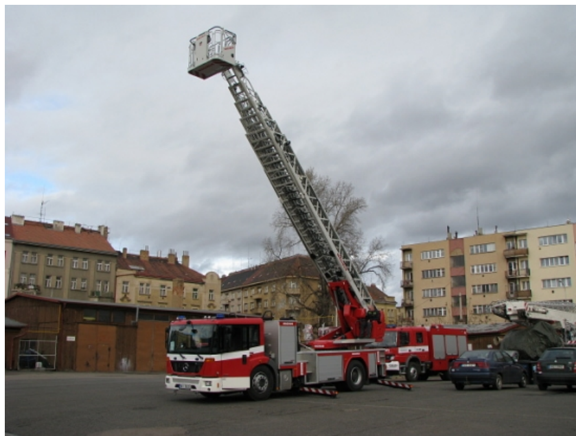
Obrázek č.4- Automobilový žebřík s dostupnou výškou 37 m na podvozku Mercedes-Benz Econic 1828 ( zdroj: www.pozary.cz )
