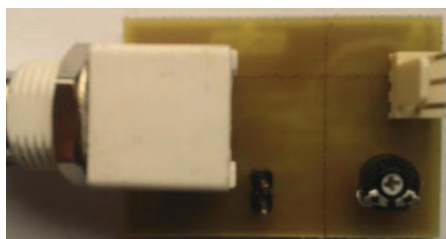
Obr. 8.7: Spodní strana osazené DPS - oscilátor s VCA
