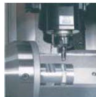
Obr. 2.5 Obrábění s využitím osy Y 5
