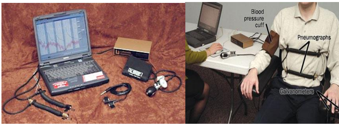
Obr.13: a) Detektor lži, b) Rozmístění elektrod
