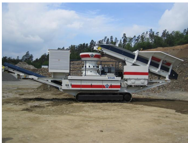
Obr. 17 Mobilní drtičí jednotka MCU 7UC-2C firmy DSP Přerov [16]
