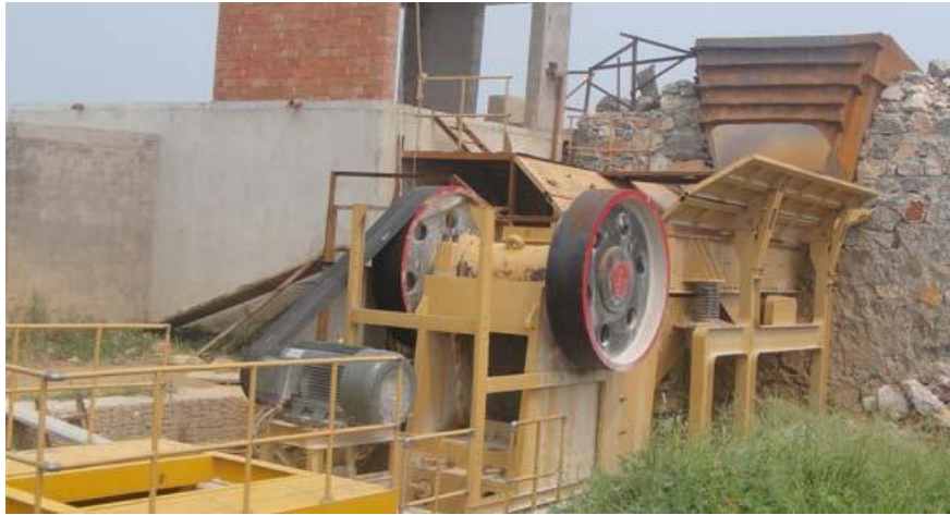
Obr. 19 Jednovzpěrný čelistový drtič poháněný elektromotorem s podavačem [18]
