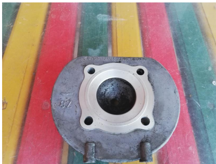
Obr. 18 Upravená hlava valca
