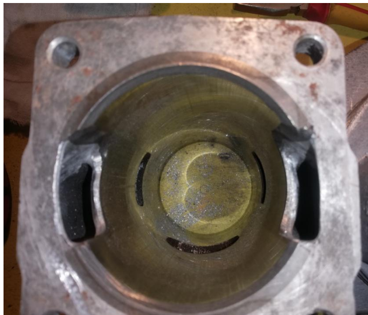
Obr. 23 Zladené prepúšťacie kanály so skriňou motora
