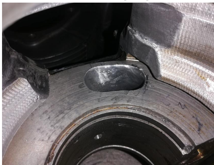
Obr. 19 Sací kanál pred úpravou
