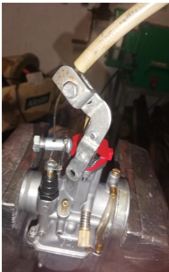
Obr. 28 Prvé nevydarené riešenie sýtiča
