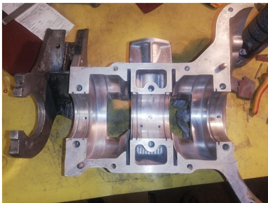
Obr. 22 Zaoblené ostré hrany a vyleštený povrch kľukovej skrine
