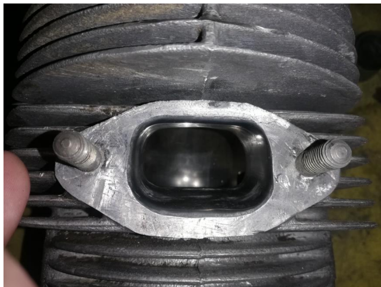
Obr. 25 Upravený výfukový kanál
