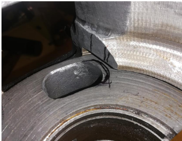
Obr. 19 Sací kanál pred úpravou
